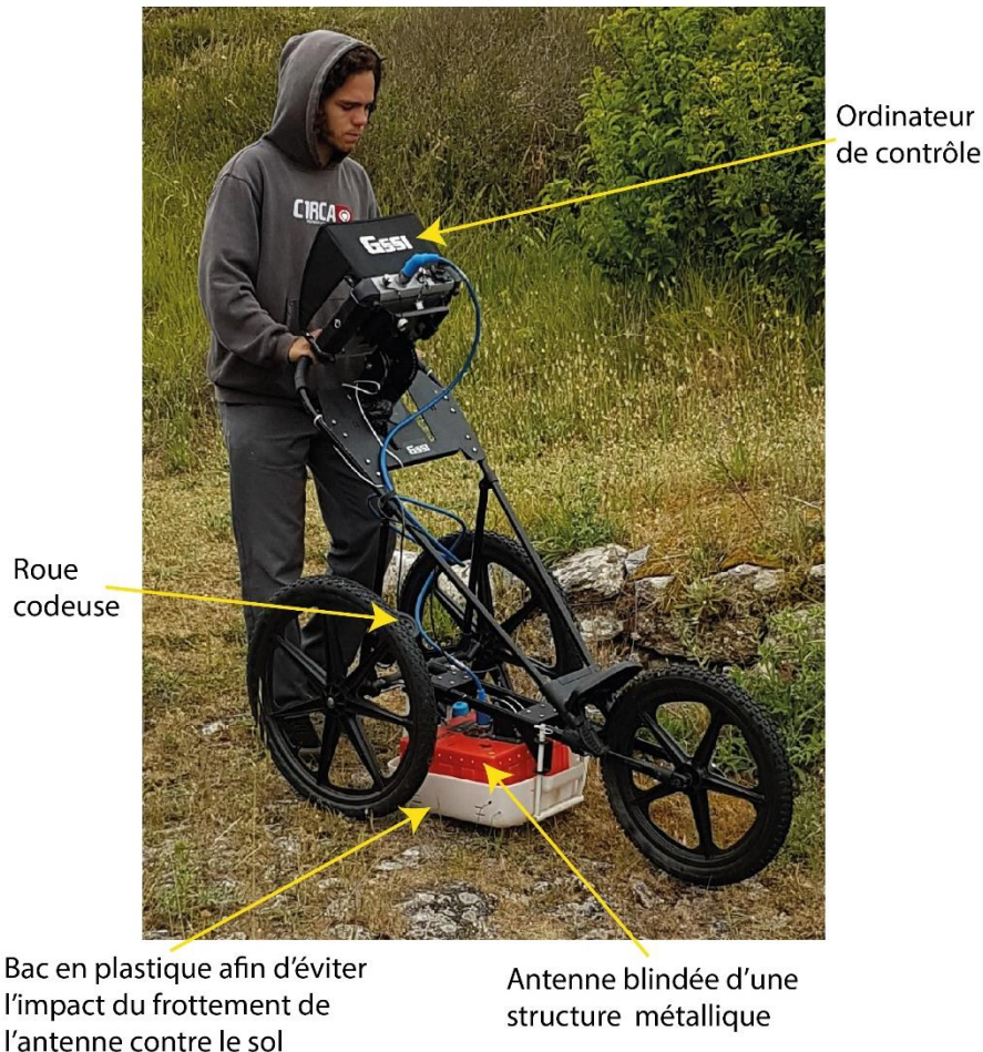
Figure 22 : Description des composantes d'un géoradar GSSI SIR-300.
