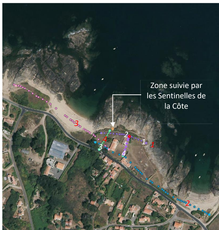
Figure 6 Position des différents profils réalisés en 2021 sur la pointe des Roses. Les numéros blancs indiquent la numérotation des profils GéoRadar. Les numéros rouges indiquent les numéros de profils de résistivité.
