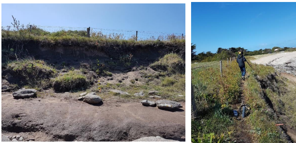
Figure 9 Profil réalisé sur le site des Roses à l'aide de la sonde TDR, vu du bas de la falaise dunaire (cliché de gauche), et vu du haut (cliché de droite). Sur le cliché de gauche, chaque petite fiche plastique jaune positionne une mesure le long du profil. Sur le cliché de droite, la sonde TDR est plantée dans le petit chemin côtier mentionné sur le graphique des valeurs (figure suivante).
