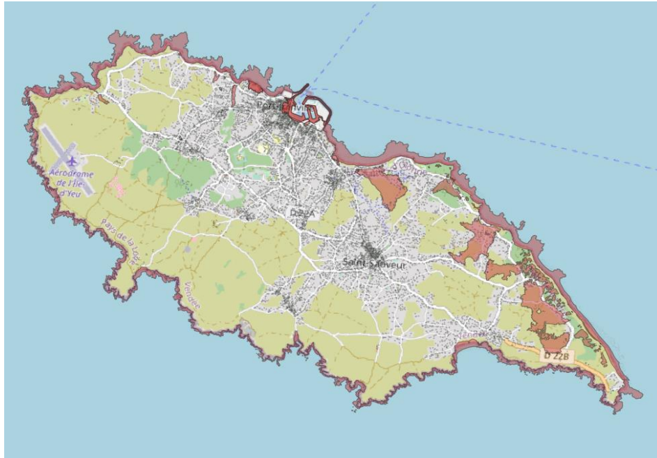
Figure 4 - Zone submergées par un aléa “extrême” (surcote de 4,8 m) (capture d’écran Qgis) (source: A. Creach)
